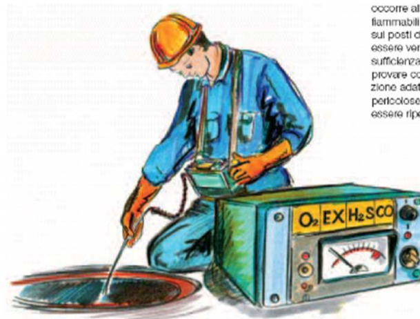
Figura 7: Prima di entrare nella canalizzazione si eseguono misurazioni per accertare l'eventuale presenza di ossigeno, gas e vapori infiammabili, idrogeno solforato, monossido di carbonio.
