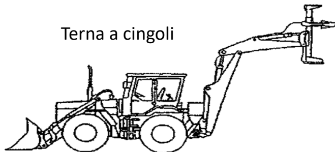
Terna con attrezzatura per posa pali
